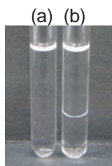
Figure 2. Comparison of miscibility between SiDAAA or TRIS and HEAA. (a) SiDAAA and HEAA. (b) TRIS and HEAA.
